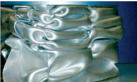
La déformation d'un capot de voiture en aluminium est fortement influencée par la nature et la structure des précipités au niveau de sa microstructure
