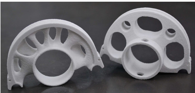
Une poulie "bio-conçue" et son homologue conventionnel
