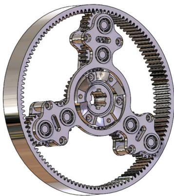
Nous avons conçu une boîte à train épicycloïdal à deux vitesses placée sur un étage intermédiaire entre la sortie moteur et la couronne de la roue arrière, avec des rapports de transmission sélectionnables de 1 et 3.
