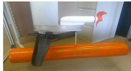
Figure 2 : Photo de la torpille, le foil et le moteur
