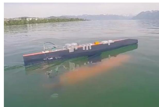
Fig.5 Photo prise lors du deuxième test avec incidence sur les stabilisateurs
