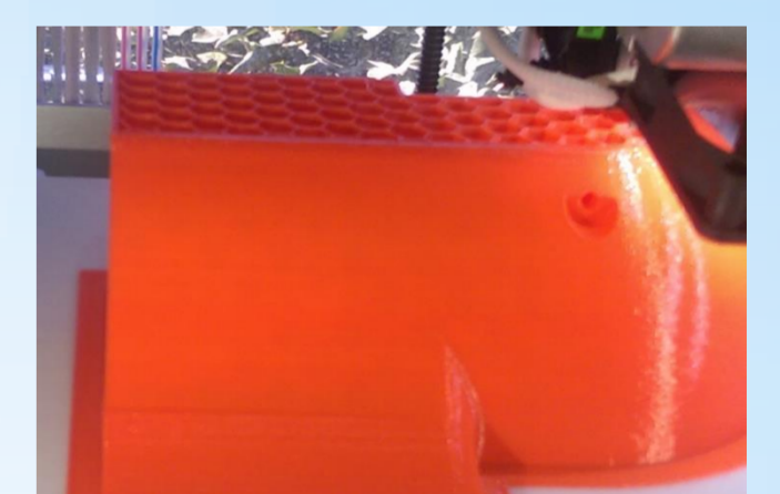
Flotteur en cours d'impression
